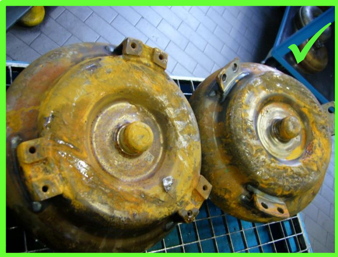
Leichter Oberflächenrost → zulässig
