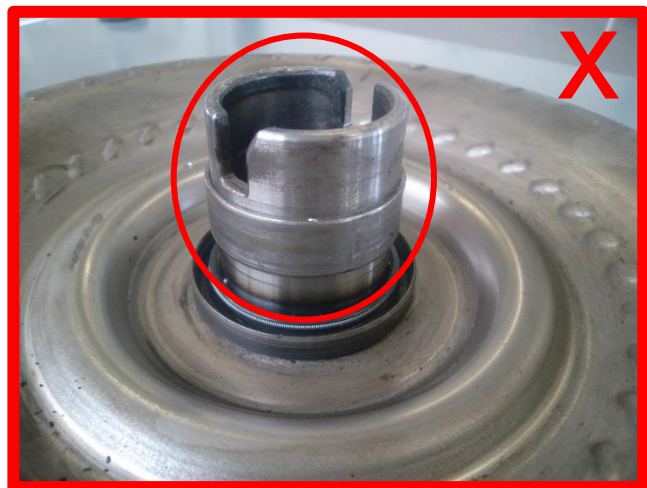
Pumpenbuchse auf der Nabe festgefressen → unzulässig
