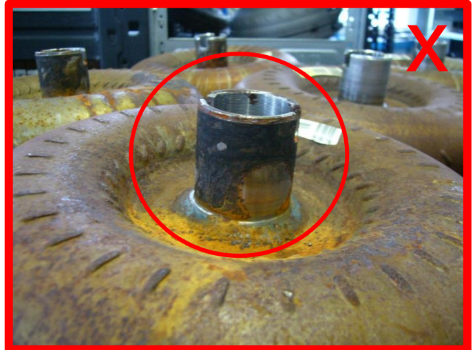
Starke Korrosion, Fraßkorrosion (insbesondere an der Nabe) → unzulässig
