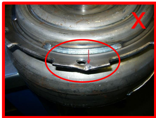
Befestigungskranz beschädigt → unzulässig
