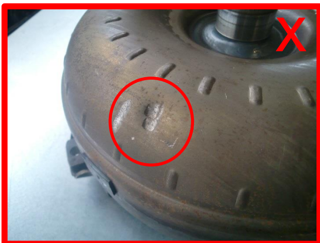
Gehäuse beschädigt → unzulässig
