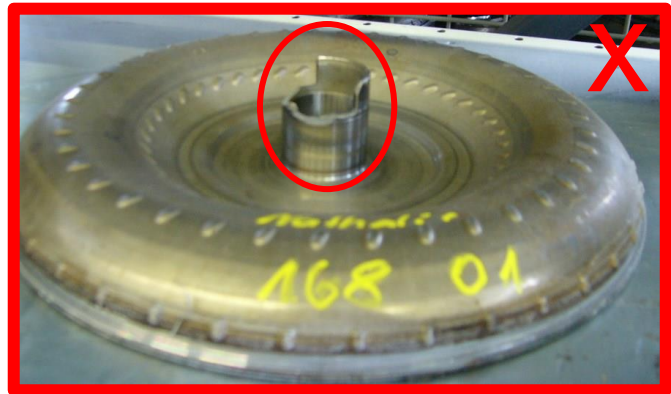
Nabe gebrochen / beschädigt → unzulässig
