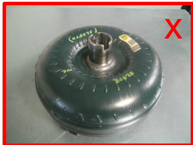
Lackierung durch Fremdreparatur, bzw. Instandsetzung durch Fremdhersteller → unzulässig
