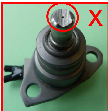
Beschädigungen der Stirnseite des Ventilkörpers → unzulässig
