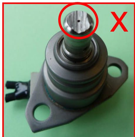
Beschädigungen der Stirnseite des Ventilkörpers → unzulässig
