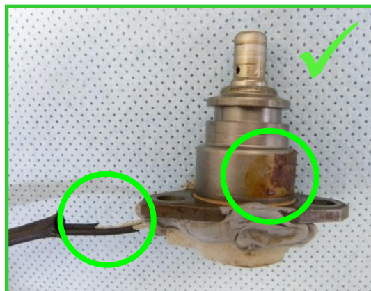
fehlende Kabel am DMV 10 → zulässig Korrosion am Ventilgehäuse / Flansch → zulässig
