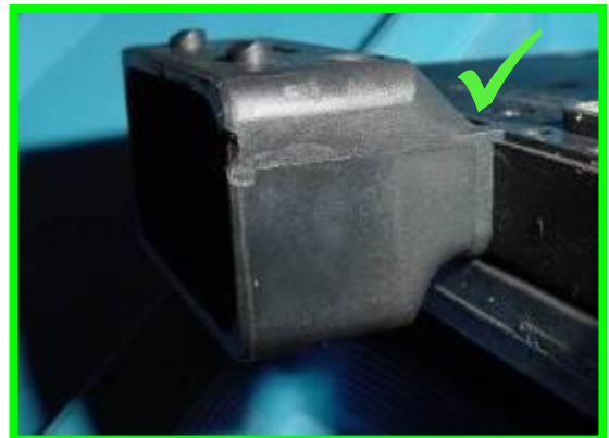
Stecker leicht beschädigt max 2mm → zulässig
