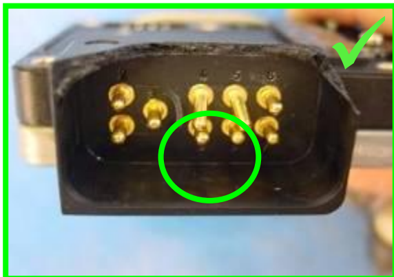
Pins beschädigt → zulässig
