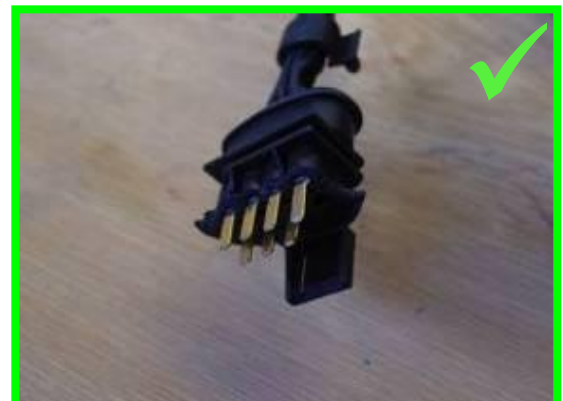
Anschlüsse defekt → zulässig
