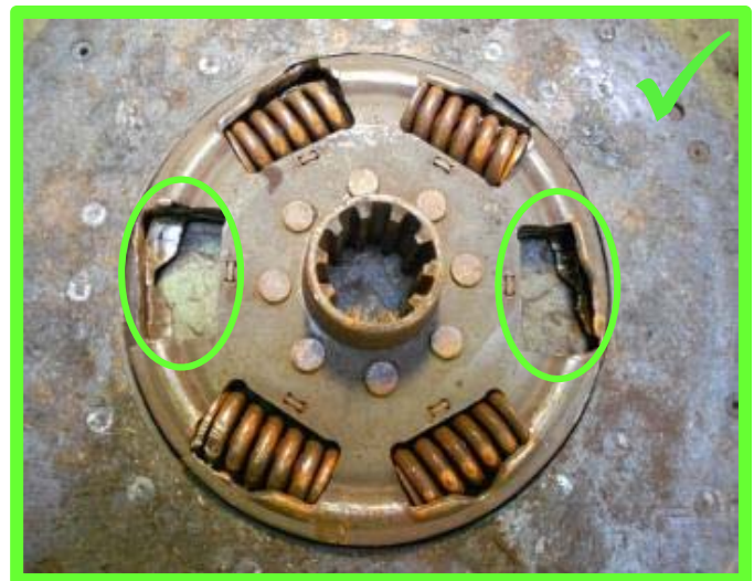
Fehlende Torsionsdämpferfedern → zulässig
