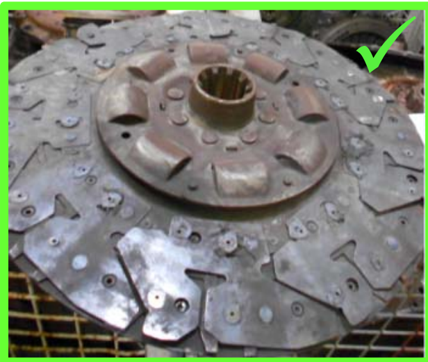
Kupplungsbelag abgerissen → zulässig
