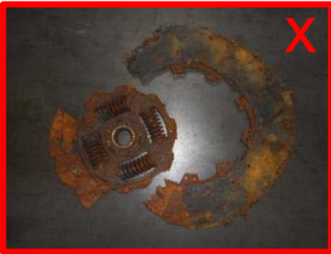
Kupplungsscheibe zerlegt → unzulässig
