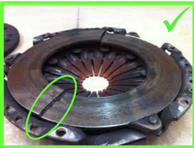
Anpressplatte gebrochen →zulässig
