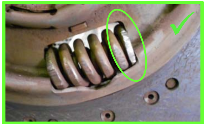
verschlissene Torsionsdämpfer- und Membranfedern →zulässig
